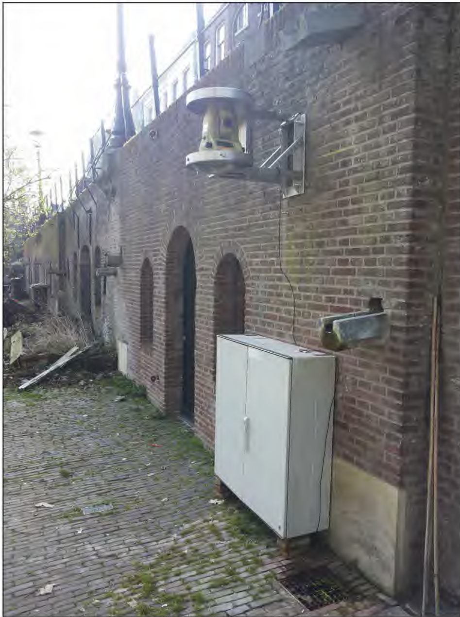
Figuur 5: Voorbeeldfoto Robotic Totalstation Leica TCA 1800
